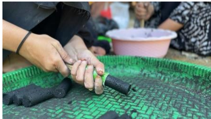
Gambar 3. Proses Percetakan Briket Sumber: Dokumentasi Tim PKM, 2026.
