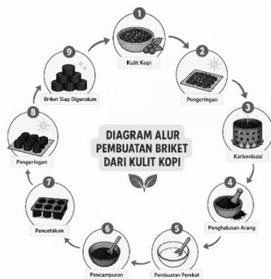
Gambar 1. Diagram Alur Pembuatan Briket dari Kulit Kopi
