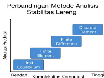
Gambar 1. Diagram Perbandingan Metode Analisis Stabilitas Lereng
