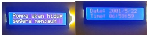
Gambar 11. Pengujian Modul Real Time Clock DS3231
