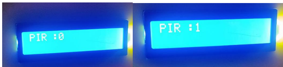
Gambar 10. Pengujian Sensor Passive Infrared (PIR) HC-SR501
