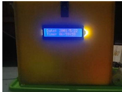
Gambar 8. Pengujian LCD I2C
